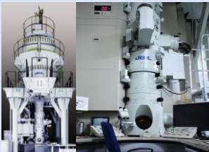
反応化学超高压走査透過電子顕微鏡
