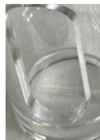
X線照射用の窓部分
