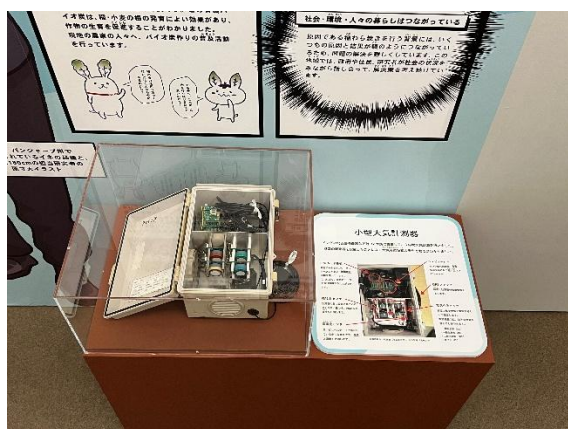
写真2) 山崎高幸技師が製作した小型大気環境測定器。大気中の PM2.5、CO、NO x 、O 3 を測定することができる。インドの農村部に32箇所設置し、3年間にわたり大気環境を測定した。
