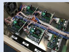
筐体と電子基板の一体的な製作技術
