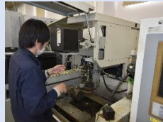
ワイヤ放電加工機による精密加工
