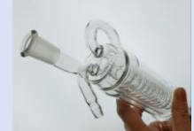
既製品にはない性能を追求した 化学実験用高效率冷却管
