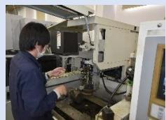
ワイヤ放電加工機による精密加工
